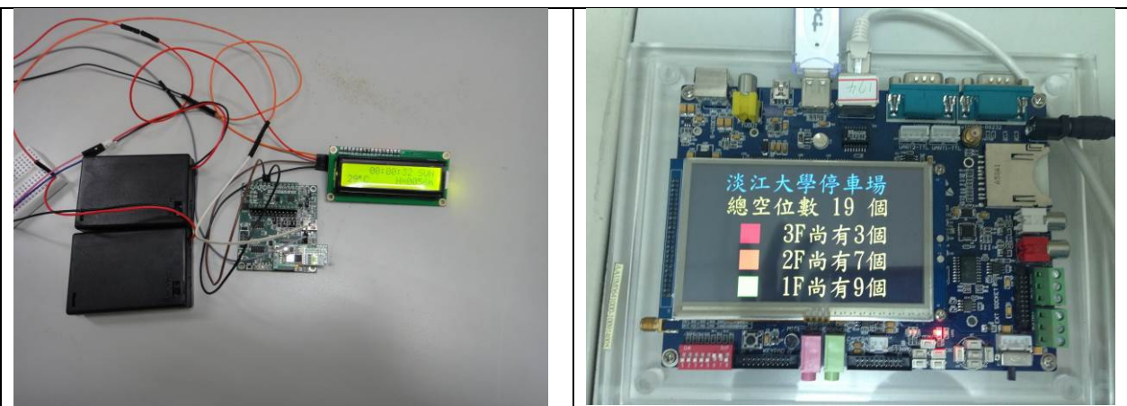
【圖 III-6-9】學生自行組裝的藍芽即時溫度，溼度與高度計
