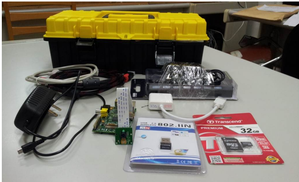
【圖 III-6-1】Raspberry Pi 單板電腦(含整理箱)，學生必須自行組裝使用
