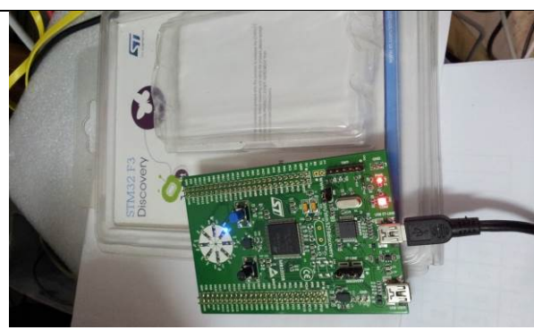
【圖 III-6-8】 STM32 F3-Discovery 微控器實驗板
