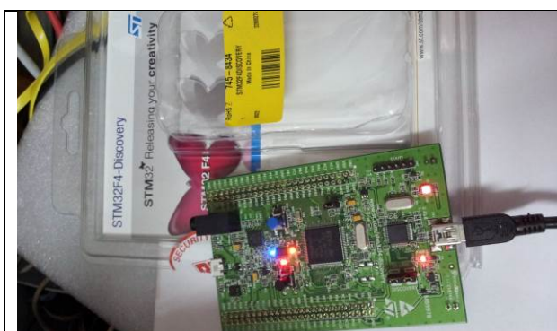
【圖 III-6-7】 STM32 F4-Discovery 微控器實驗板
