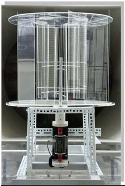
圖 9.3.4-2: 應用於阻力型垂直軸式風力發電機之漩渦流集風罩
