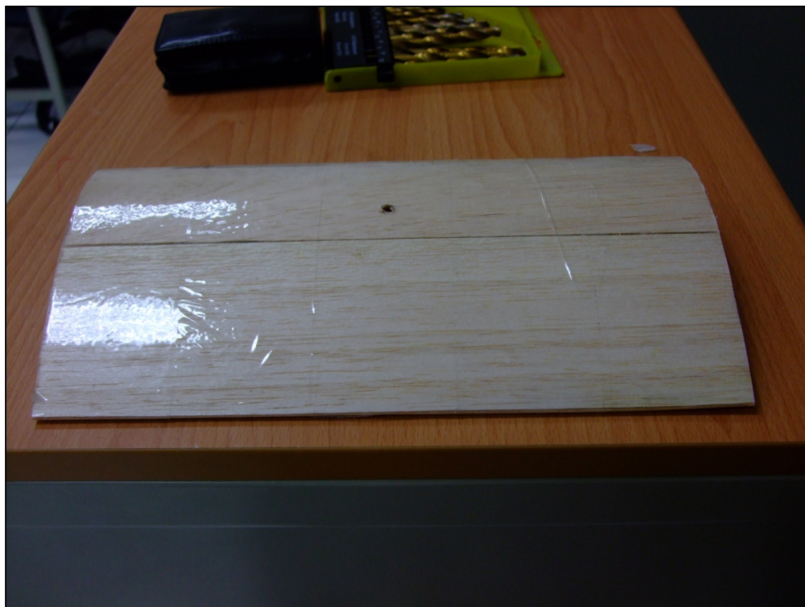
圖 4-4: 將輕量化葉片骨架包覆木皮做成葉片
