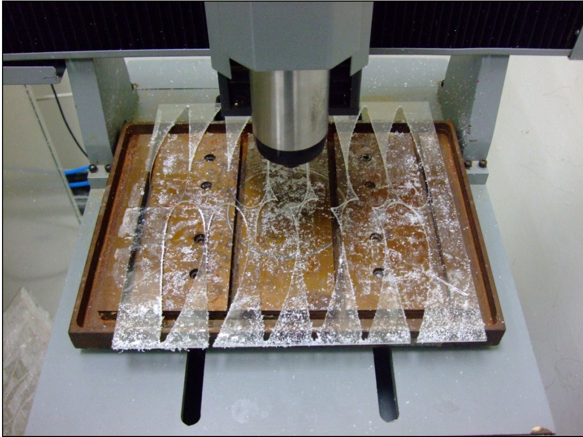
圖 4-2: 利用雷射雕刻機在壓克力片上切割葉片翼形
